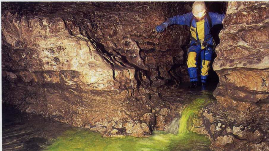
Injection de fluorescéine au fond du gouffre n°5 de la Haie Cabuche en juin 1997. Photographies Stéphane Jaillet.
